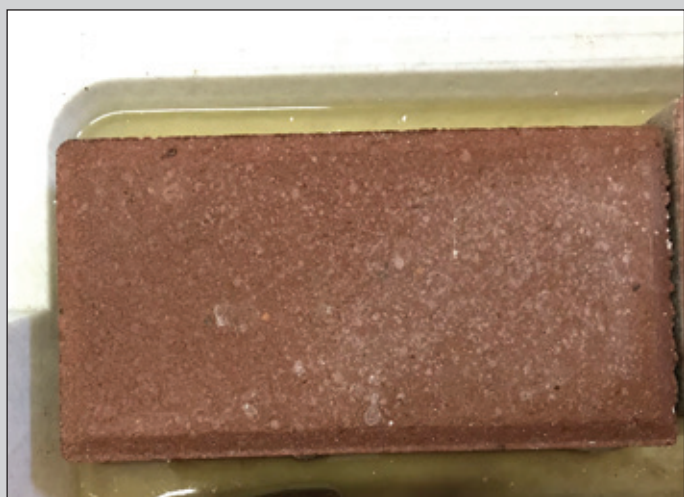
Фотография 7. Обработанная гидрофобизатором плитка в солевом растворе (через 2 месяца)
