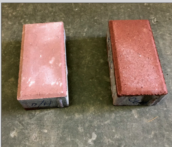
Фотография 3. Обработанная гидрофобизатором «Неогард -3/ДК» плитка (справа) и плитка без обработки (слева).
