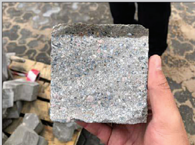
Рис. 2. Разность степени водопоглощения бетона различных слоев.
