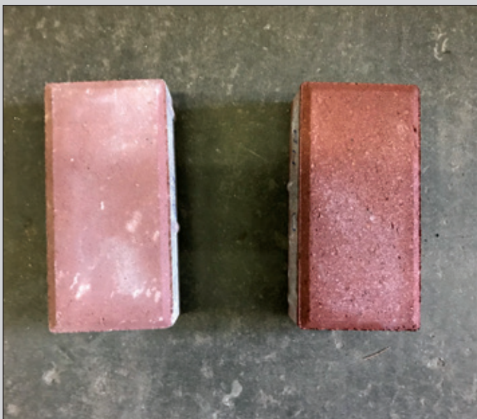
Фотография 2. Обработанная гидрофобизатором «Неогард -3/ДК» плитка (справа) и плитка без обработки (слева).
