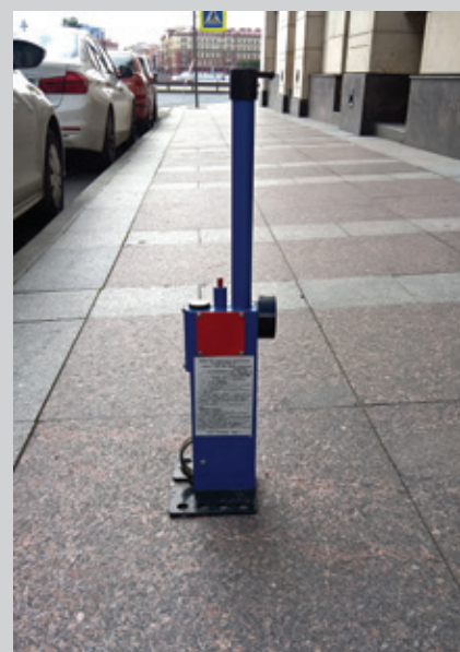
Рис.2. Измерение сцепных свойств лицевой поверхности с применением прибора ПОКС-2.
