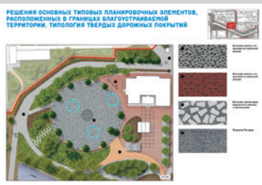
Проект благоустройства в Екатеринбурге (КБ "Стрелка") предполагал использование многоугольных плит в сочетании с покрытием из гранитной крошки с закреплением эпоксидным вяжущим.
