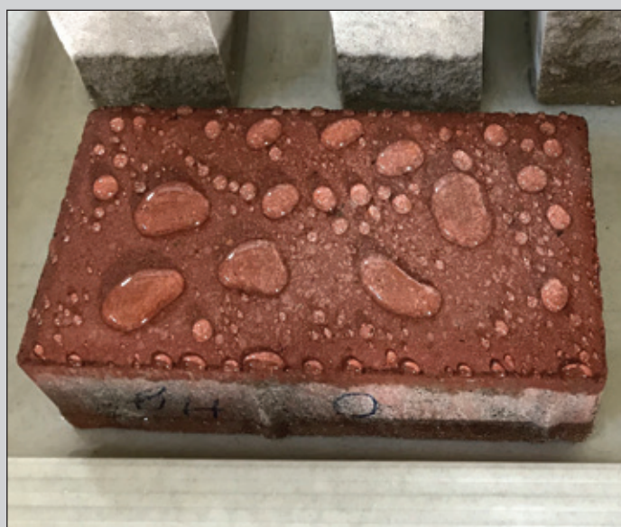
Фотография 5. Обработанная гидрофобизатором плитка помещена в солевой раствор и полита сверху водой.
