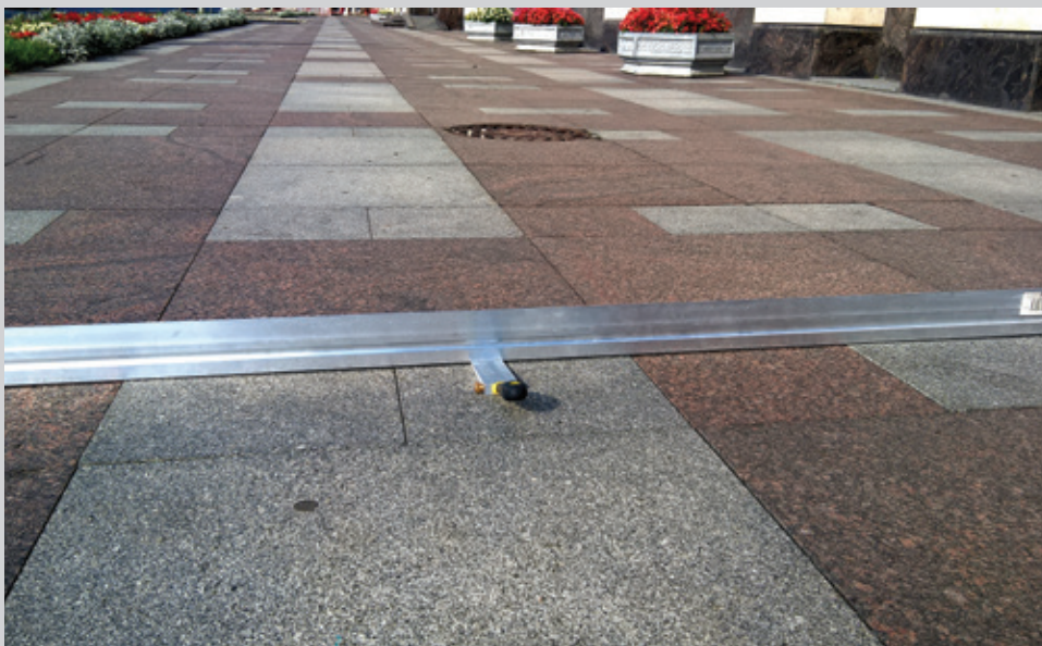
Рис. 3. Процесс измерения ровности покрытия с помощью рейки и клиновидного промерника.
